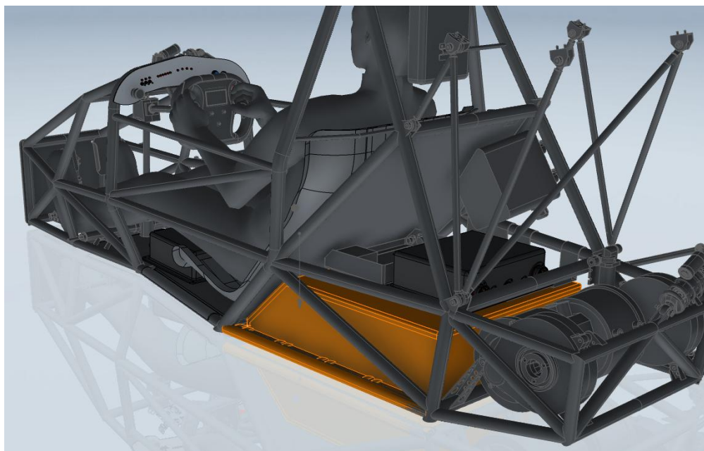
Obrázek 6 – Umístění trakční baterie ve voze (vlastní zpracování)
